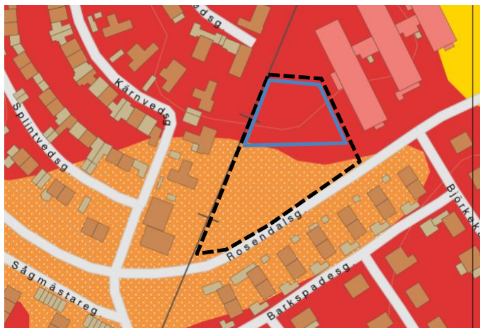
Figur 3. Utsnitt från SGUs jordartskarta (rött: urberg, orange: postglacial sand, gult: glacial lera). Kartan är automatiskt framställda från SGUs databas 2018-12-05, www.sgu.se . Planerat område för förskola markerat med svart streckad linje och den skogbeklädda slänten är markerad med blått.
